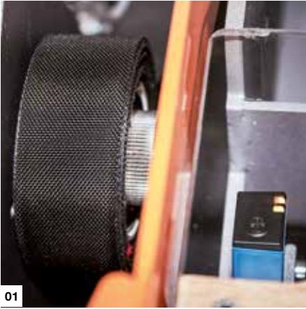
01 Die sensorische Bandende-Erkennung (optional erhältlich) sorgt für optimale Abläufe in der Fertigung.
