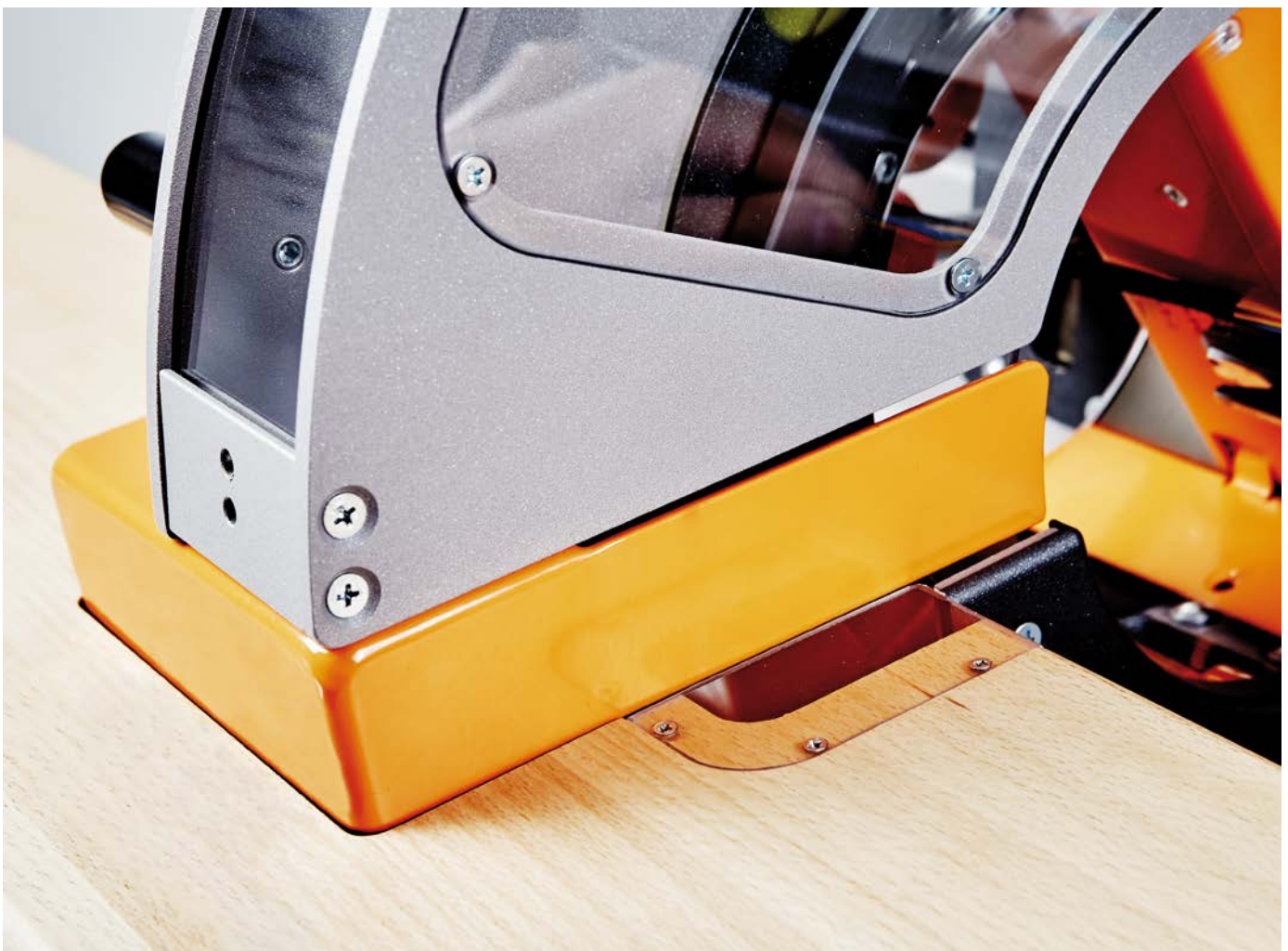
01 Die sensorische Bandende-Erkennung (optional erhältlich) sorgt für optimale Abläufe in der Fertigung.
